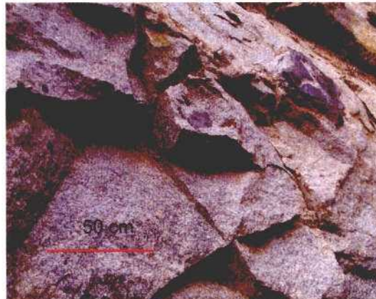
Fotografía 3: Aspecto del granito sin alterar, en el que se observan enclaves de esquistos negros.
