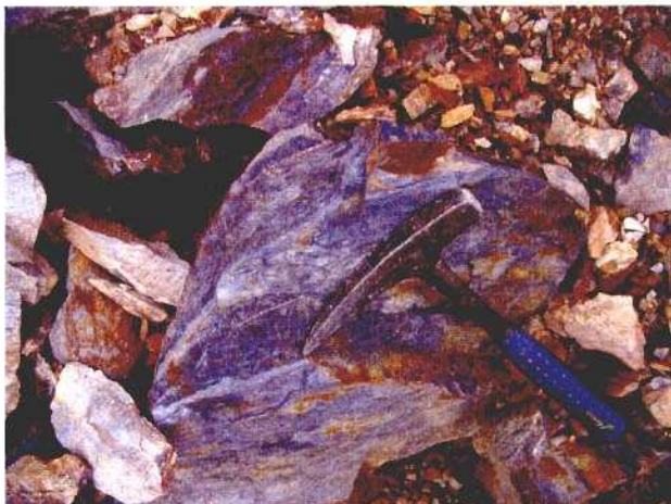
Fotografía 27: Detalle de un esquisto en la cantera Ladairo.
